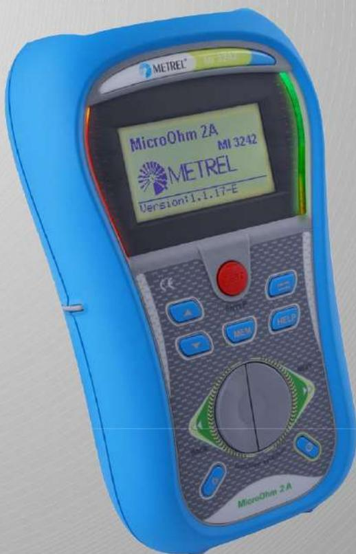
MI 3242 MicroOhm 2A - это портативный омметр малых сопротивлений, который предназначен для измерения низких сопротивлений переключателей, реле, разъёмов, шин, соединений силовых распределительных кабелей, обмоток двигателей и генераторов, силовых трансформаторов, силовых индукторов, рельсовых соединений, сопротивления проводов и кабелей, сварных соединений для промышленного применения и т.д., с тестовым током до 2А.
